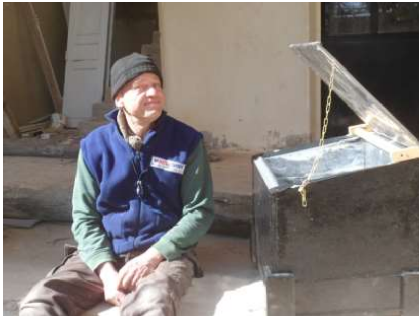
Zonnekoker in aanbouw. Ontbreken nog: de spiegel bovenaan en het glas bovenop.
